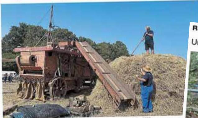
Les bénévoles séparent les grains de blé de la paille à l'aide d'une batteuse des années 1920.
